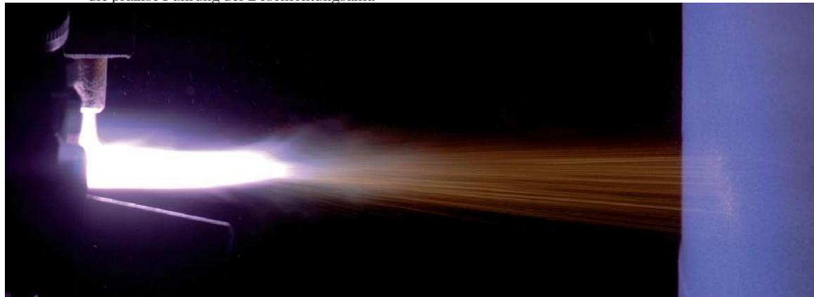
Im 20.000 °C heißen Plasmastrahl entstehen optimale Gegenlaufflächen aus Keramiksichten.
