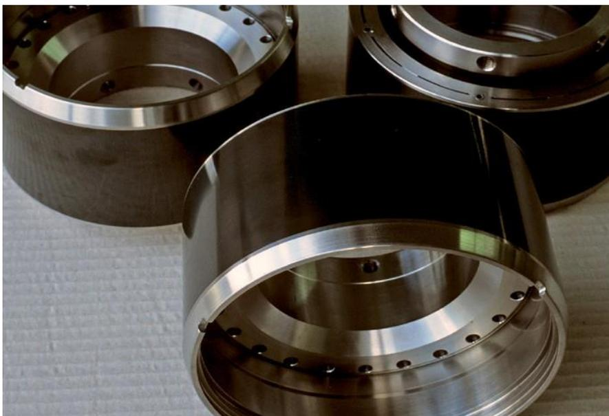
Verschleißhülse aus einer Schweißkonstruktion aus Edelstahl /Nickel die mit einer keramischen Beschichtung die halben Herstellkosten und eine 3,8 fache Lebensdauer zur bisherigen Konstruktion erreicht. Bilder: Putzier
