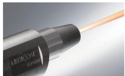
Beim Hochgeschwindigkeitsflammspritzen (HVOF) werden Hartmetalle mit Überschallgeschwindigkeit auf das zu beschichtende Objekt geschossen.
